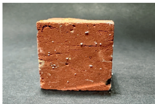
圖 2-1-9 · 研發群組「以硼砂為結晶修飾劑提升文化資產抗鹽害風化能力之可行性研究」添加適量結晶抑制劑的磚石進行鹽害試驗後之試片（國立成功大學）
