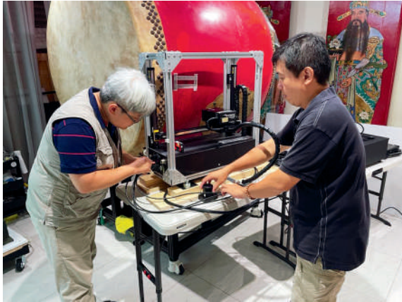
圖 5-2-4 · 獨木大鼓太赫茲檢測儀器設置
