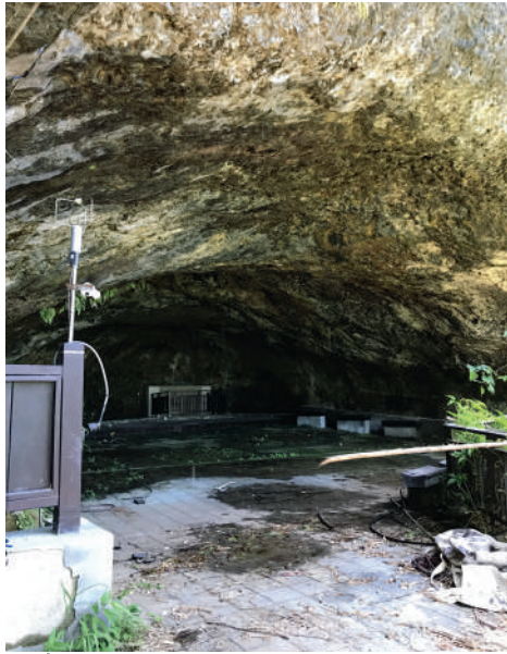
圖 5-1-6 · 文化資產監測儀器設置攝影機及三維超音波風向風速計－八仙洞考古遺址
