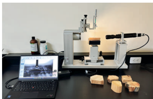
圖 2-1-8 · 研發群組「開發木質文物表面有機矽烷型撥水防腐保護層之研究」接觸角量測進行木質試片疏水測試（正修科技大學）
