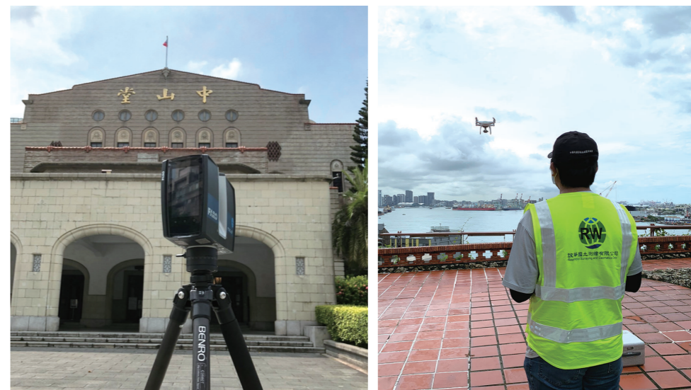
圖5-1-1 · 3D掃描作業衛星定位測量－旗後礮臺
