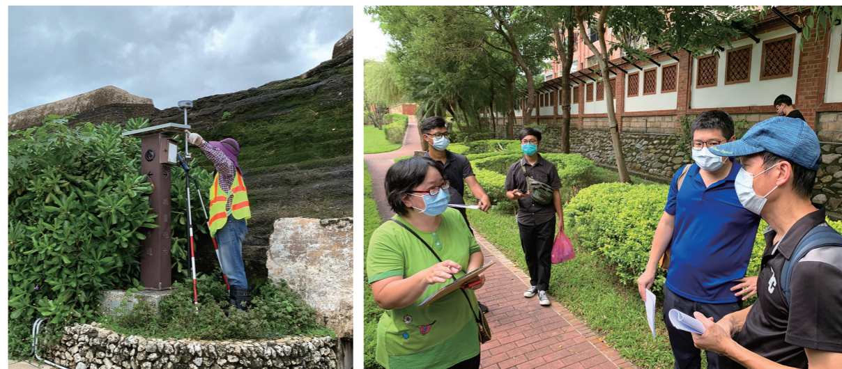
圖5-1-1 · 3D掃描作業衛星定位測量－旗後礮臺
