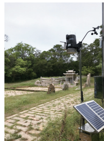
▶ 圖5-1-5 · 文化資產監測儀器設置綜合氣象站一陳建墓
