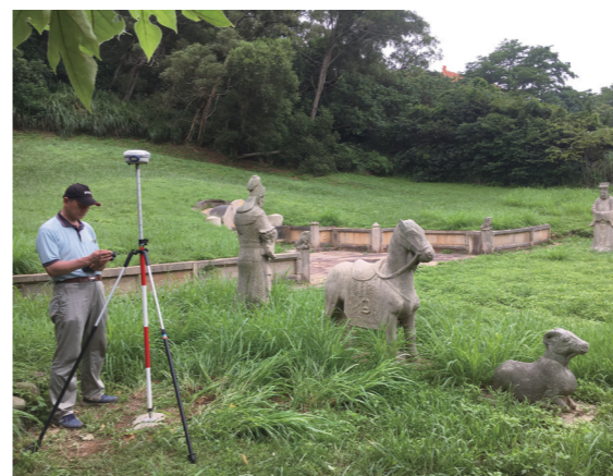
圖5-1-1 · 3D掃描作業衛星定位測量－鄭用錫墓
