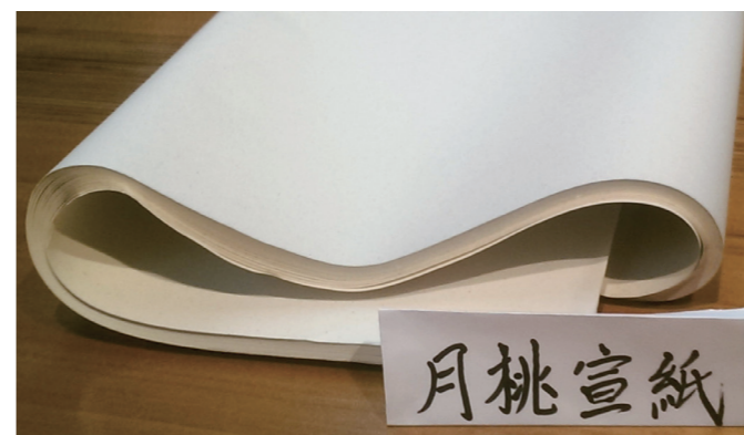
▶圖2-1-7·文化資產學院研發群組「以本土植物纖維原料月桃葉鞘研製修護用手工紙之探討」計畫研製月桃宣紙，兼顧文資保存、經濟及環境資源
