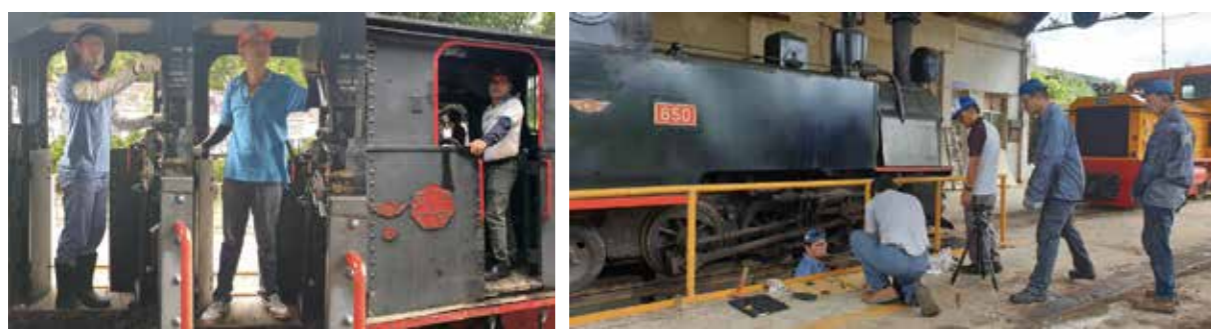
圖2-3-23、2-3-24 · SL650蒸汽機車修復及蒸汽機車駕駛資格培訓作業
