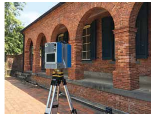
圖5-1-1·淡水紅毛城雷射掃描作業
