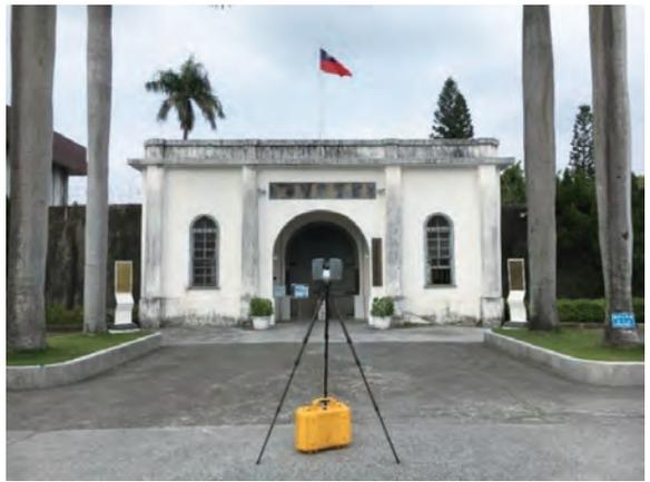
圖 5-1-1 | 嘉義舊監獄雷射掃描現場作業
