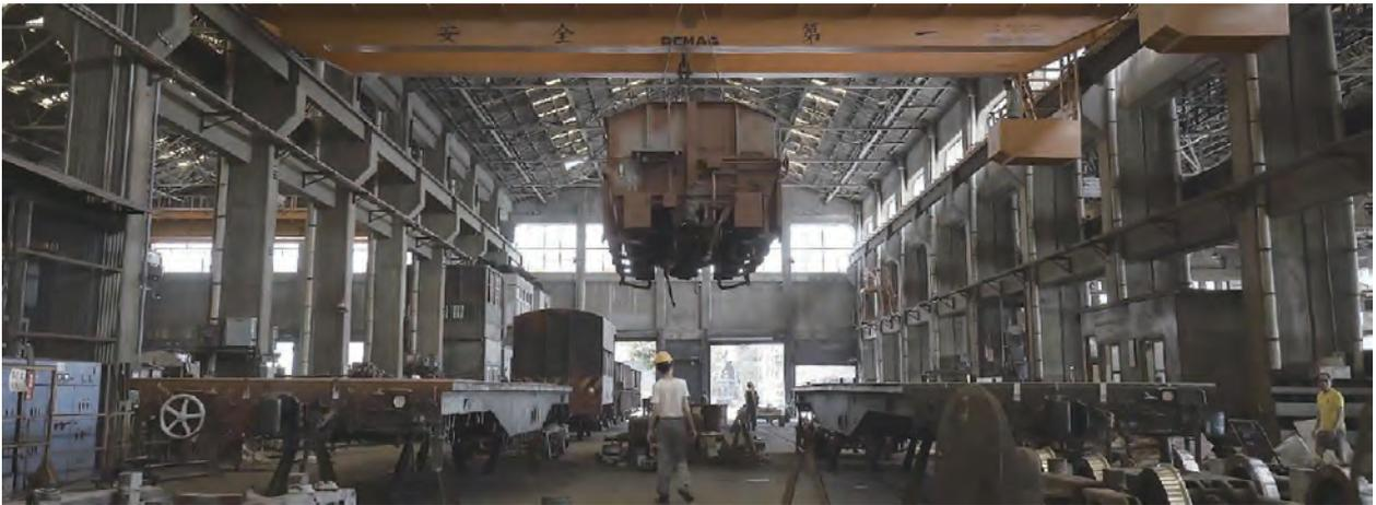
圖 2-2-4 | 高雄機廠貨車工場吊貨車車體現場工作情形
