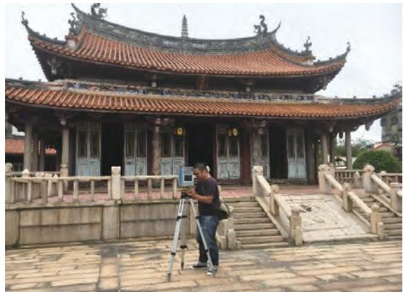
圖 5-1-4 | 彰化孔子廟雷射掃描現場作業
