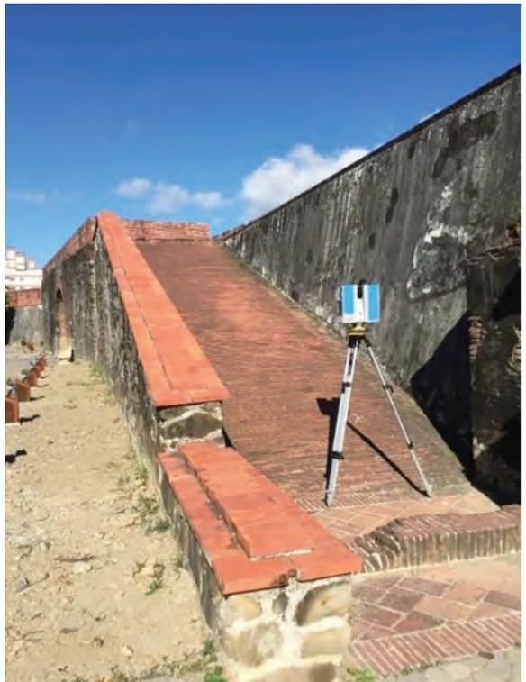
圖 5-1-3 | 屏東恆春古城雷射掃描現場作業
