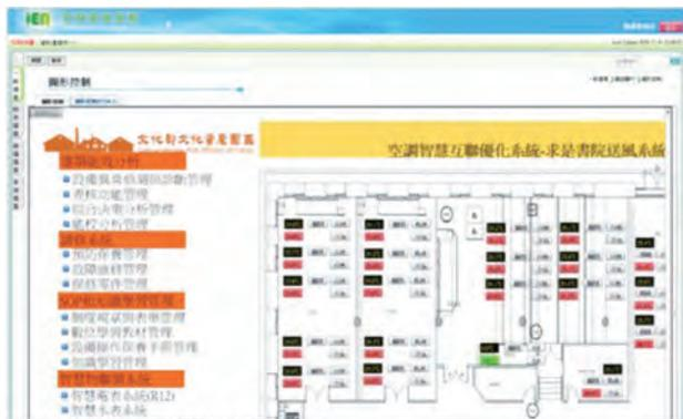
圖 6-1-6 | 整合式管理平臺空調系統監控畫面
