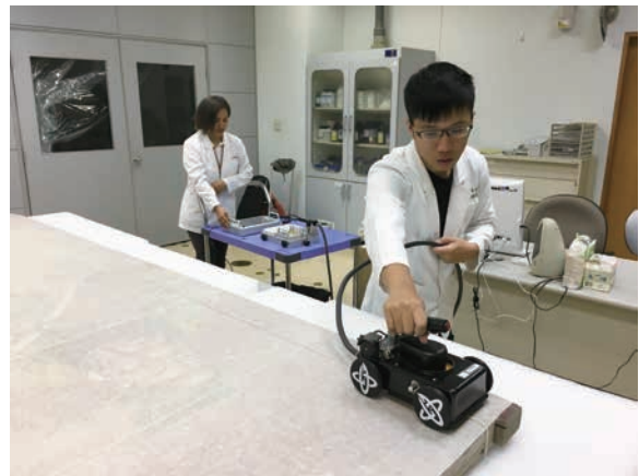
圖 5-2-4 | 透地雷達檢視是否有結構內部缺陷
