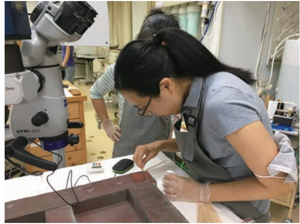
圖 5-2-2 | 於門神背面進行清潔溶劑測試
