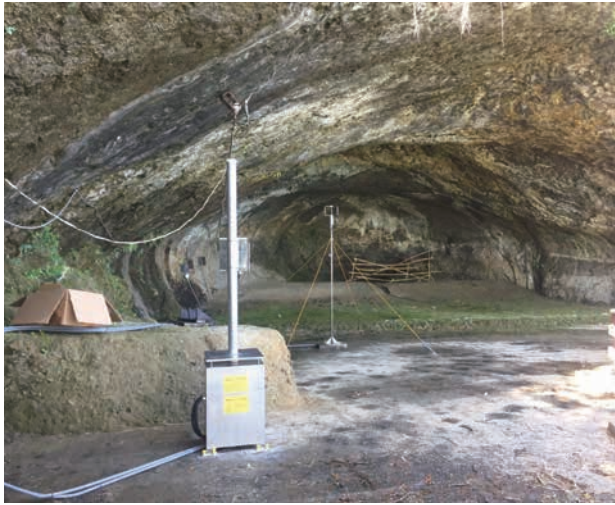
圖 5-1-1 | 文化資產監測儀器設置超音波風向風速計及攝影機 -- 八仙洞遺址
