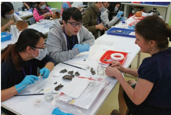
圖 5-2-20 | 陶瓷器黏合材料示範
