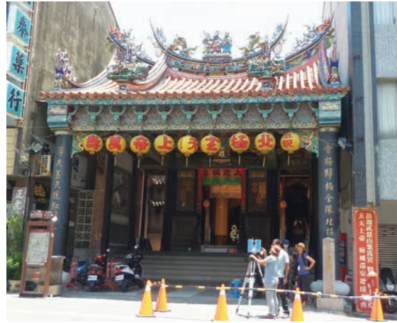
圖 5-1-7 | 國定古蹟北極殿雷射掃描現場作業
