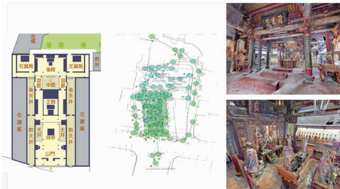
圖 5-1-5 | 臺灣府城隍廟基站掃描站位圖及彩色點雲
