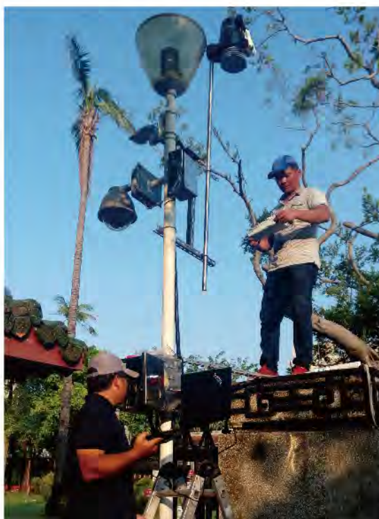
【圖5-1-3】文化資產監測儀器設置綜合氣象站—臺南赤崁樓
