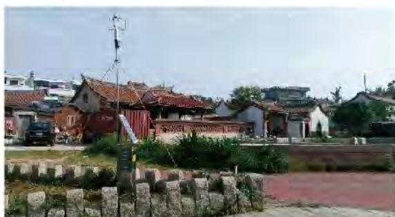
【圖5-1-1】文化資產監測儀器設置超音波風向風速計—金門水頭黃氏西堂別業
