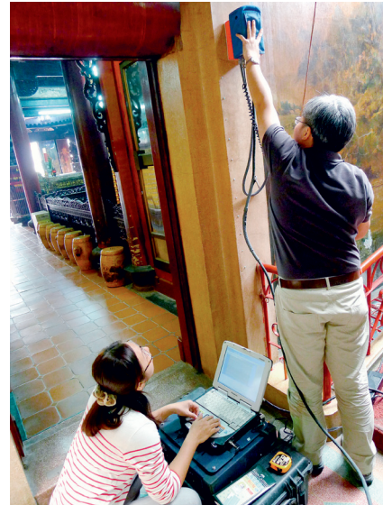
以透地雷達進行壁體檢測
